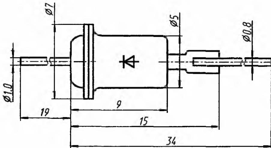
KC133A, KC139A, KC147A, KC156A, KC168A выпускаются в стеклянном корпусе с гибкими выводами. Для обозначения типа и полярности стабилитрона используется условная маркировка — голубая кольцевая полоса со стороны катодного вывода и разноцветные кольцевые полосы по сторонам анодного вывода: KC133A — белая, KC139A — зеленая, KC147A — серая, KC156A — оранжевая, KC168A — красная. В режиме стабилизации напряжения полярность включения стабилитрона обратная.
